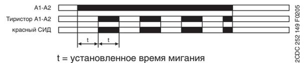
**X<sub>3</sub>-X<sub>4</sub>** перемычка: 0,1-10 с      **X<sub>3</sub>-X<sub>4</sub>** без перемычки: 3-300 с
