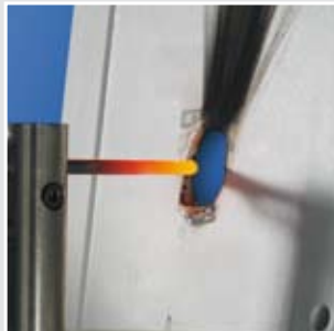
Характеристика горения: Проверка нитью накала в соответствии с IEC 60 695-2-1: 750 °C, огнестойкий , самозатухающий
